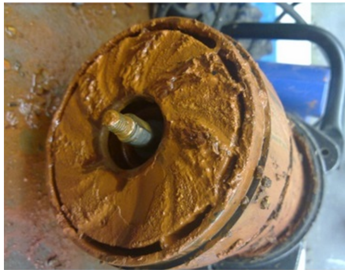
Abbildung 19: Verockerung an einer Pumpe
