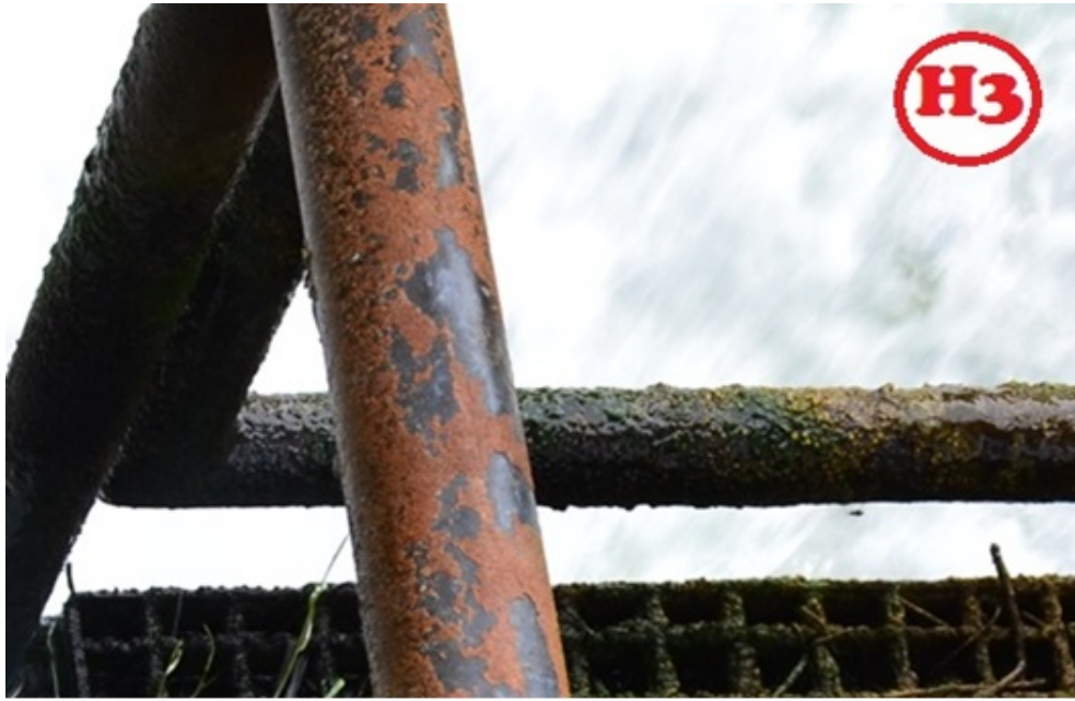
Abbildung 30: Abgelöster Biofilm am Zinkgestell der Harpener Teiche
