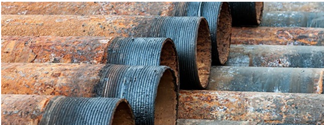
Abbildung 3: Korrodierte Rohre aus einem industriellen Wassernetz
